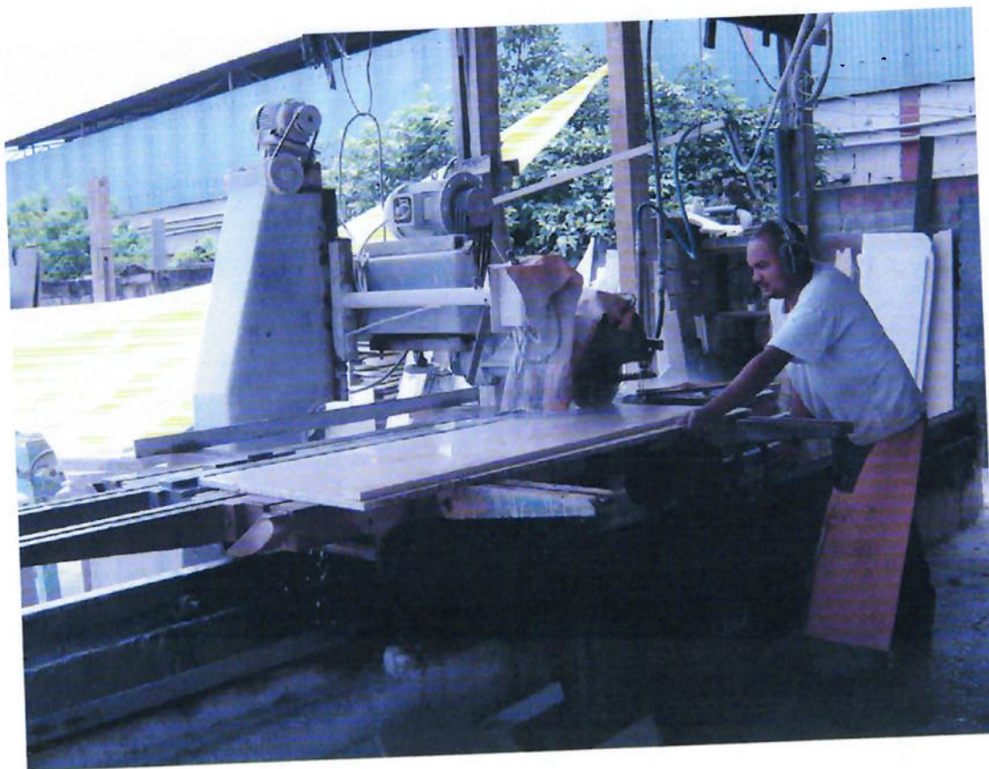
Fig. 8.7 - Serra para corte unidirecional.
