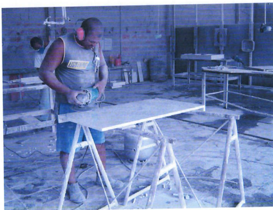
Fig. 8.11 - Acabamento de desbaste a seco
