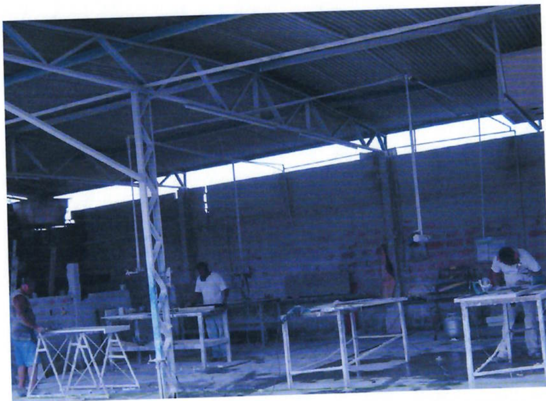
Fig. 10.4 - Setor de acabamento com rede aérea para pneumáticos e água.
