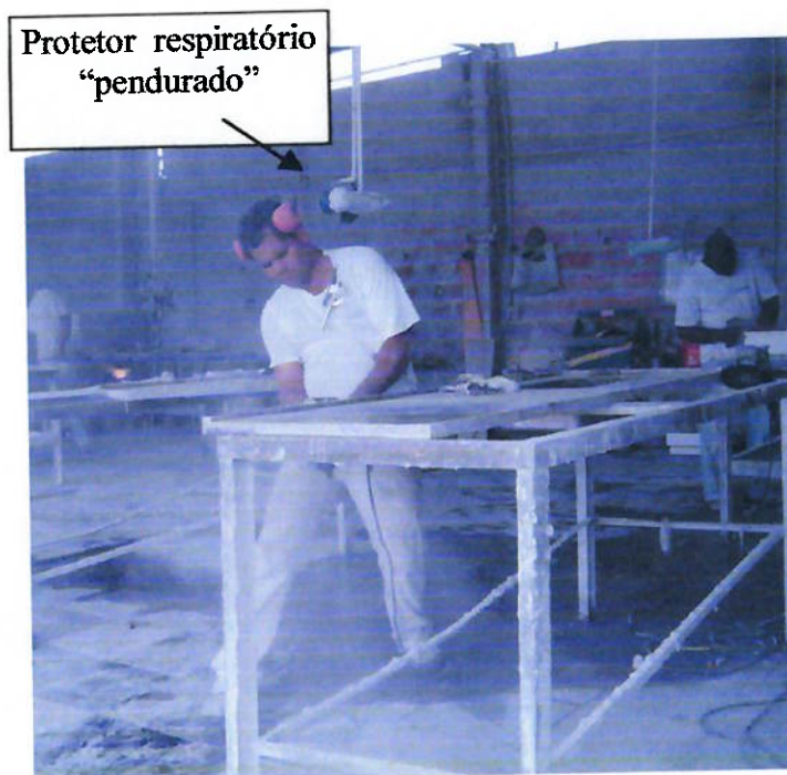
Fig. 8.14 - Serviço de desbaste a seco
