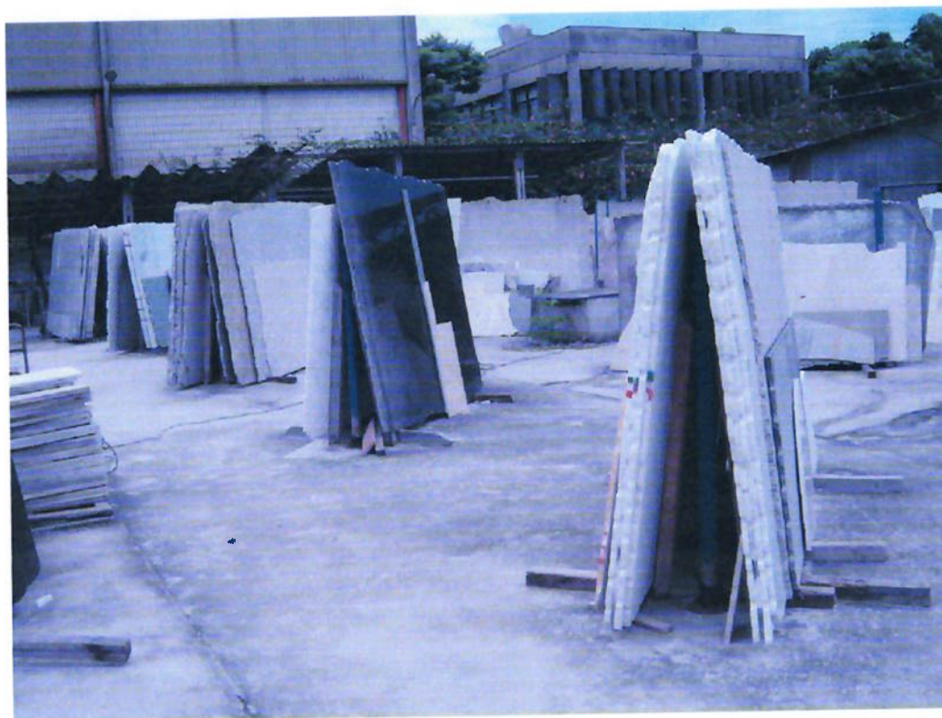
Fig. 8.3 - Pátio de estoque cavaletes metálicos com chapas.
