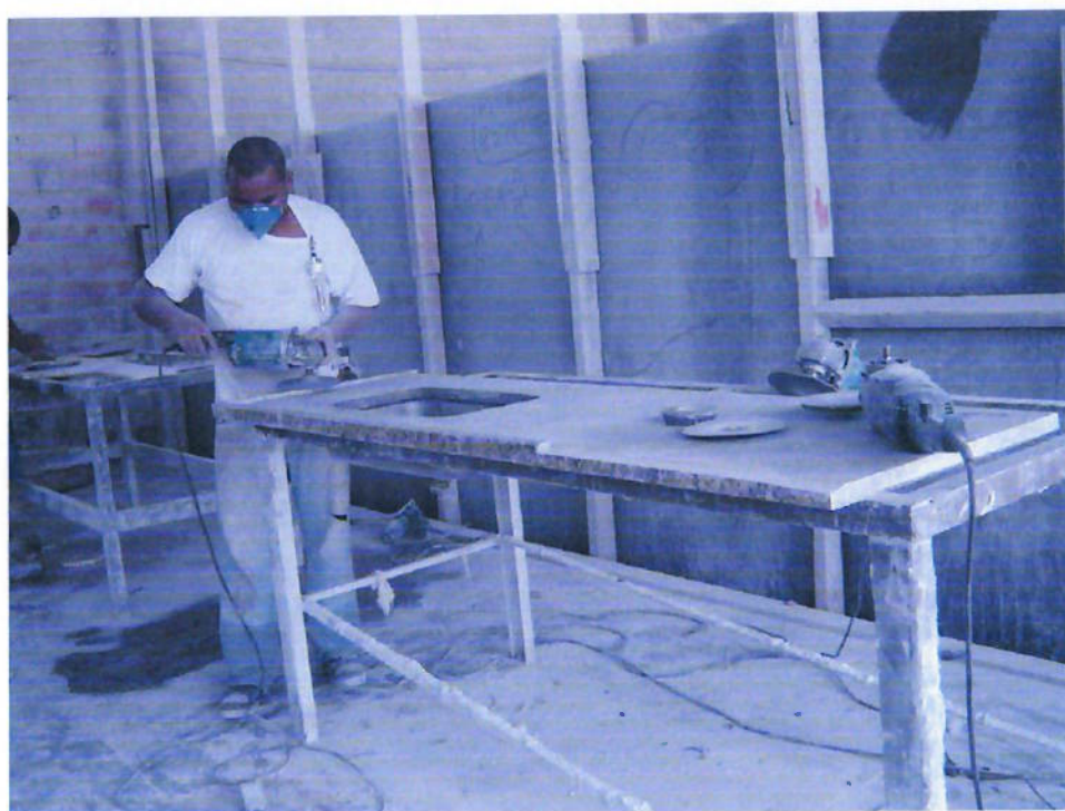
Fig. 8.15 - Operador fazendo desbaste
